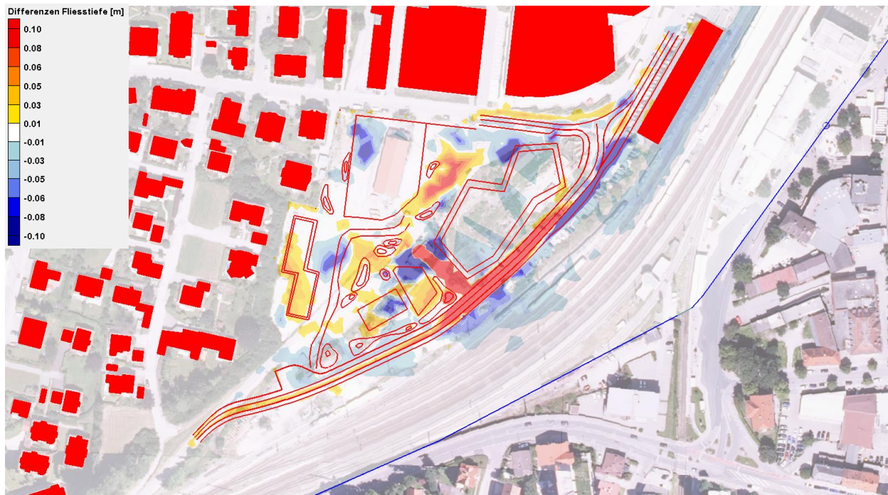
Abbildung 10.7: Differenzendarstellung Fließtiefen Plan- Ist, HQ 10 , 30-Minuten-Regen (Geobasisdaten: Bayerische Vermessungsverwaltung, 2023)
