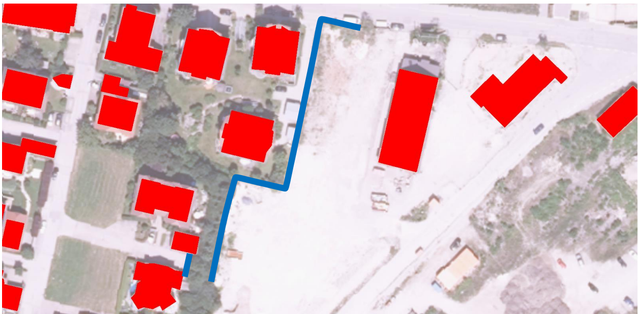
Abbildung 6.5: Lageplan undurchströmbar modellierte Mauerabschnitte (blau) (Geobasisdaten: Bayerische Vermessungsverwaltung, 2023)
