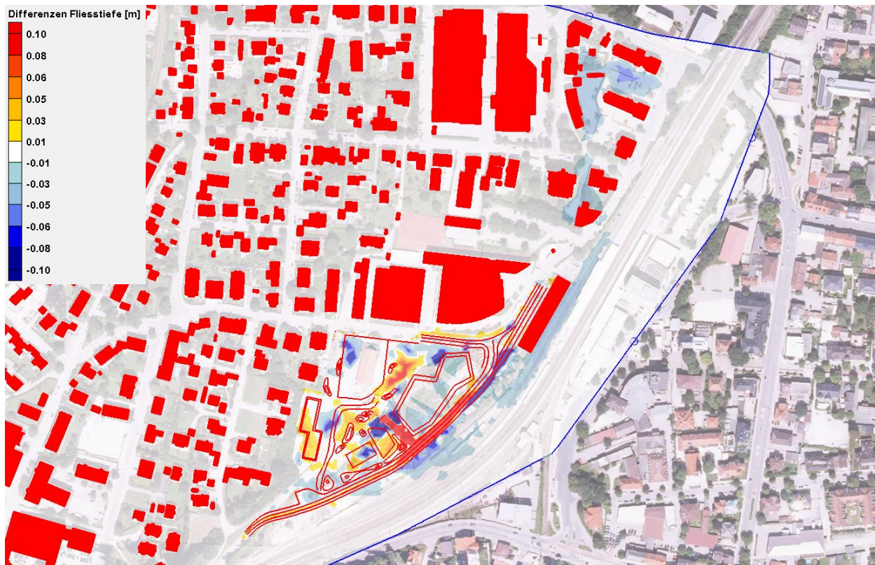
Abbildung 10.8: Großräumige Differenzendarstellung Fließtiefen Plan- Ist, HQ 10 , 30-Minuten-Regen (Geobasisdaten: Bayerische Vermessungsverwaltung, 2023)
